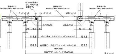
※支持部材(支柱・ブラケット)を必ず両側に2本(個)以上ずつ設置してください。 ※支柱用側面ブラケット・支柱用側面ブラケットNとの併用はできません。
