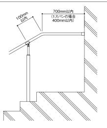
※転倒・転落を防ぐため、階段などの段差付近や足元が滑りやすい場所では、必ず手すりを連続させてください。
